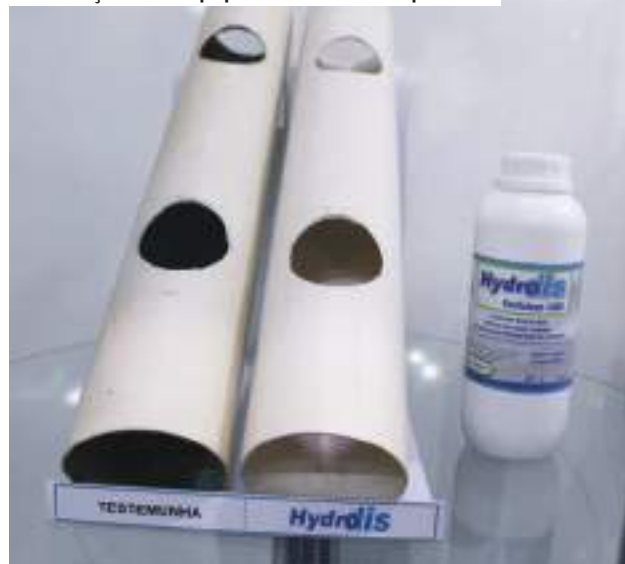
O Hydrodis é um produto inovador para remover incrustações em equipamentos de hidroponia
