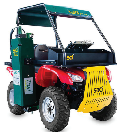
Figura 5. Exemplo de equipamento para coleta de amostra de solo, na agricultura de precisão.
