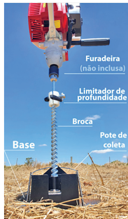
Figura 5. Exemplo de equipamento para coleta de amostra de solo, na agricultura de precisão.
