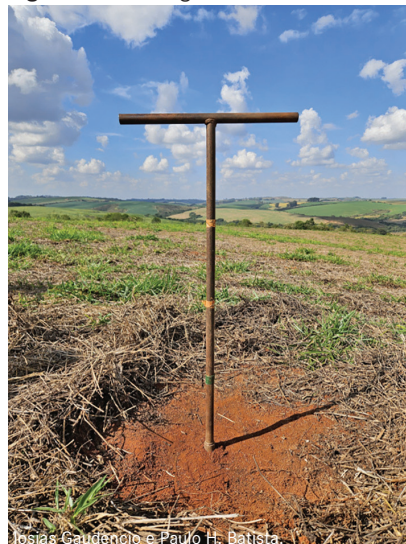
Figura 1. Amostragem de solo com o trado holandês.
