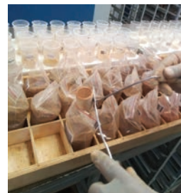
Figura 1. Tamanhos de cachimbos para medida do volume das amostras (A) e processo de cachimbagem das amostras para análises químicas (B).
