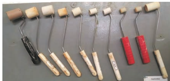
Figura 1. Tamanhos de cachimbos para medida do volume das amostras (A) e processo de cachimbagem das amostras para análises químicas (B).
